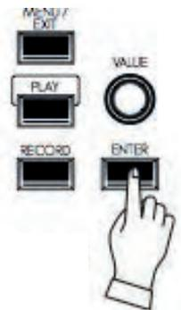
Appuyer sur le bouton [ENTER]. Le contenu du mode « MANUAL » est initialisé.
