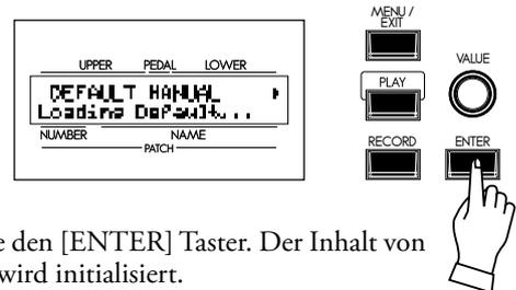
Drücken Sie den [ENTER] Taster. Der Inhalt von MANUAL wird initialisiert.
