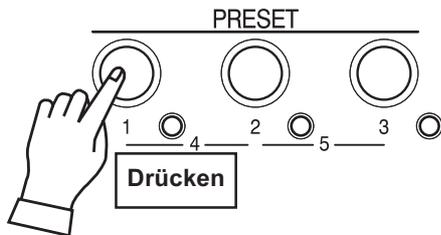
Jeder auf die Preset Taster [1], [2], [3] registrierte Patch wird durch Drücken des einzelnen Tasters aufgerufen. Um die auf die Presets 4 und 5 registrierten Patches aufzurufen, drücken Sie die Preset Taster [1] und [2] bzw. [2] und [3] gleichzeitig.
