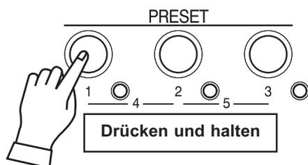
Um die aktuelle Einstellung in einen Preset Taster abzuspeichern, halten Sie den Preset Taster gedrückt, bis das Licht blinkt und lassen Sie ihn dann los. Die aktuellen Einstellungen sind in den Patches, die den Preset Tastern zugewiesen sind, abgespeichert. "Recording Patch..." wird am XM-2 für wenige Sekunden angezeigt.
