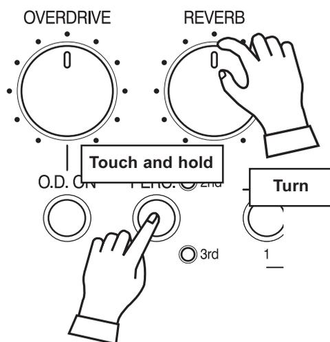
Die Lautstärke der Perkussion kann durch gleichzeitiges Gedrückthalten des [PERC] Tasters und Drehen des [REVERB] Knopfes geändert werden. Es gibt 2 Perkussions-Lautstärken (NORM und SOFT) im XM-2. Hiermit wird die gerade ausgewählte Lautstärke geändert.
