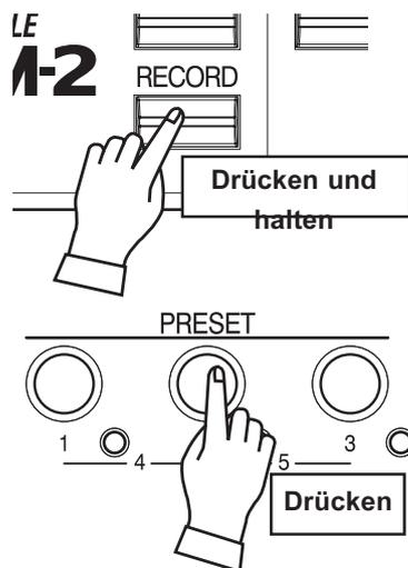
Um eine Patch Nummer einem Preset Taster zuzuweisen, rufen Sie zuerst den Patch am XM-2 auf und drücken Sie den Preset Taster an diesem Gerät, dem Sie den Patch zuweisen wollen. Wenn Sie gleichzeitig den [RECORD] Taster am XM-2 gedrückt halten, wird "Recording Preset..." am XM-2 für wenige Sekunden angezeigt und der Preset Taster an diesem Gerät blinkt für kurze Zeit.
