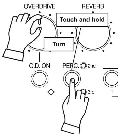
Die Ausklingzeit des Perkussionstones kann durch gleichzeitiges Gedrückthalten des [PERC] Tasters und Drehen des [OVERDRIVE] Knopfes geändert werden. Es gibt zwei Möglichkeiten der Ausklingzeit im XM-2 (SOFT und FAST). Hiermit wird die aktuell ausgewählte Ausklingzeit geändert.
