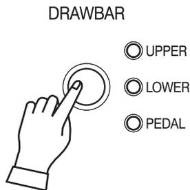
Drücken Sie den [DRAWBAR] Taster 3 oder 4 mal und wählen Sie die Parts zur Einstellung der Registrierung. Immer wenn Sie den Taster drücken, leuchtet das ausgewählte der 3 Lichter auf (UPPER, LOWER, PEDAL). Wenn Sie den Taster noch einmal drücken, ist keine Funktion (NIL=ungültig).
