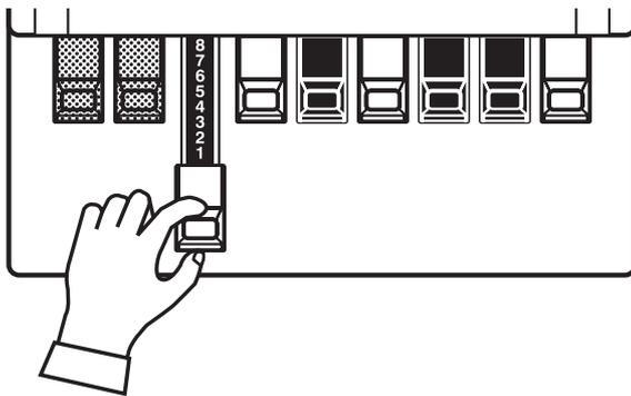
Die Registrierung der UPPER und LOWER Parts wird von allen 9 Zugriegeln reguliert, der PEDAL Part von den 16' und 8' Zugriegeln.
